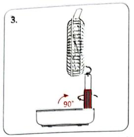
打开风扇后,将角度调至垂直90°,然后 逆时针旋转手柄至120°卡紧固定角度.
