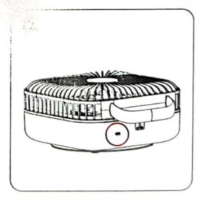
Type-C充电接口 使用常规DC 5V 2A充电器充电
