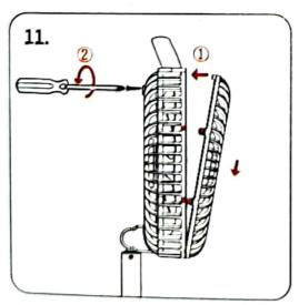
①待面罩静置干燥后,将面罩倾斜对准扣位装回.
