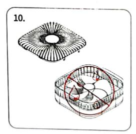
面罩可拆卸取出清洗灰尘 机身可用干布擦拭,严禁水洗.
